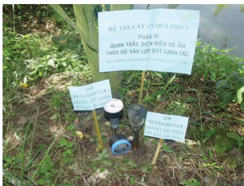
Hình 14. Tensiometer quan trắc độ ẩm đất
